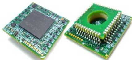
【機能追加版】 BGA他デバイスから PLCC変換
