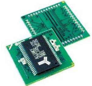
SOIC から PLCC へ変換した量産用表面実装アダプタ
