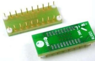
SOIC から DIP 変換アダプタ
