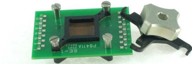
0.5mm ピッチ 21x21 列 289ピン BGA から AMP 104068 コネクタへフレキ基板を通じて接続(ソケット部分にはんだ実装不要)
