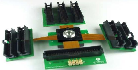
0.5mm ピッチ 21x21 列 289ピン BGA から AMP 104068 コネクタへフレキ基板を通じて接続(ソケット部分にはんだ実装不要)
